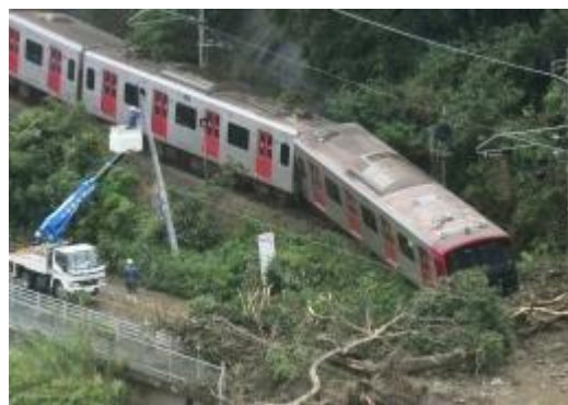
線路内に土砂が流れ込み脱線したJR筑肥線の電車
